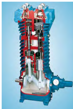
Рис. 3. Поршневой газовый компрессор серии HD Blackmer, работающий без смазки
