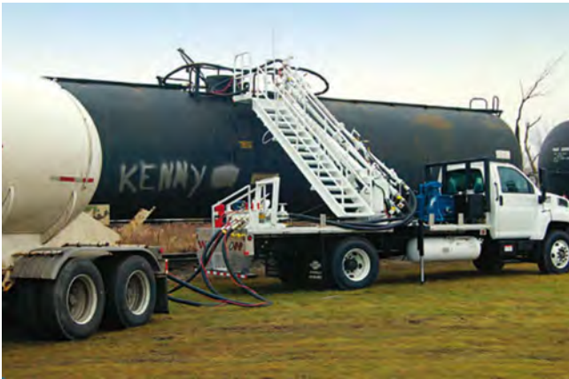
Рис. 2. Использование компрессора Blackmer при перегрузке сжиженного природного газа из железнодорожной цистерны
